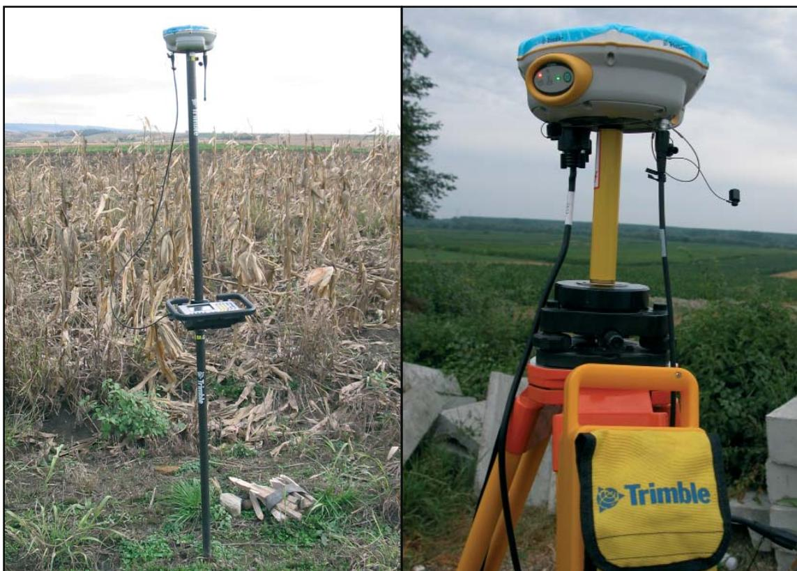
Slika 3. Trimble GPS 5800 Totalna stanica: GPS rover (levo) i bazna stanica za korekciju lokacije putem radio signala (desno) (foto: N. Mrđić).
